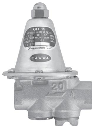
GD-15 型减压阀是适用于集体住宅的低噪声水用减压阀。对于供水侧压力的变动,二次压力保持在极度恒定的水平,内置过滤器,且产品设计小型轻便,便于管道排管。GD-15C 型减压阀内置防逆流结构,可防止逆流供水总管道。
