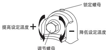
本产品出厂时初期设定温度为 48℃。调整设定温度时，请调整调节螺母。设定温度范围在 38-65℃。调整设定温度需六角扳手（与产品同捆提供）和其他扳手（市场销售）。六角扳手附带于保温材料中。
