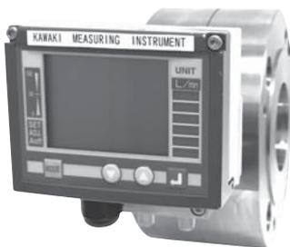
ODF 型系列流量计是通过压差计测量孔板前后产生的压差变化计算并显示流量。另外，可以在压差计上安装报警接点或通过交换压差计进行远程传输。
