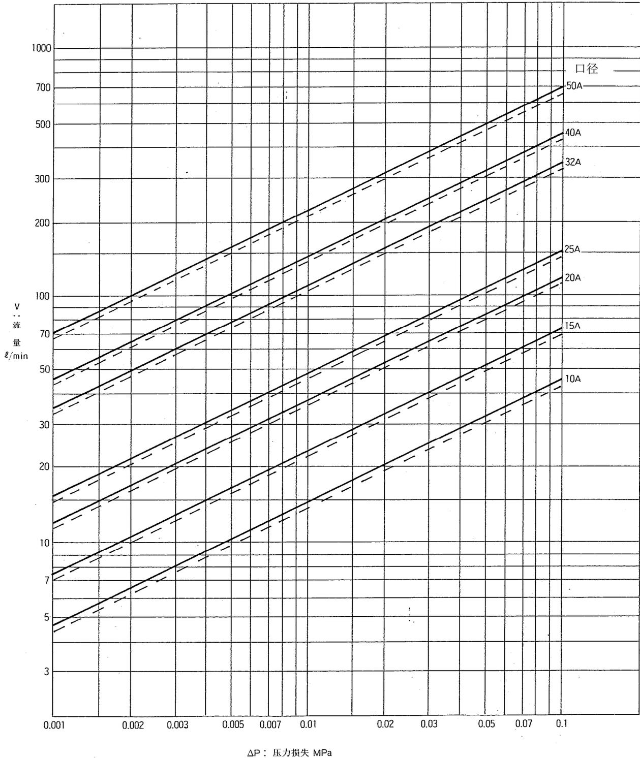
※各种口径选择图表的性能值为参考值。根据配管条件和使用环境的变化，考虑安全率高于性能值20%进行选择。
